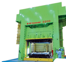
亀山事業所に導入されたプレス機は大型化する補修板金部品の生産が可能
