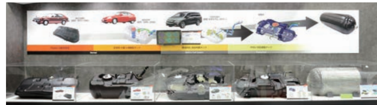
主力製品である燃料タンクの進化として、当社が初めて手がけた鉄製と樹脂製、“電動化”向けの最新技術を展示
