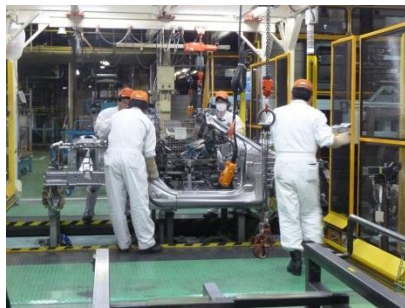
溶接工程のインナー治具工法
